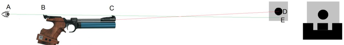
La prise de la ligne de mire s'effectue sur un fond blanc afin de distinguer en permanence le bon alignement des instruments de visée (segment BC).
