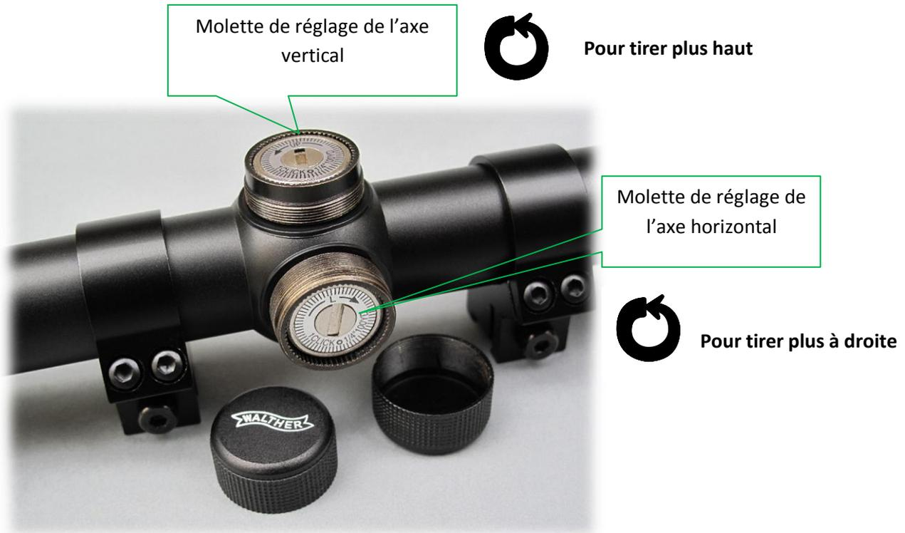
Pour se rappeler du sens de réglage, comparer votre action au mouvement d'un bouchon à visser sur une bouteille.
